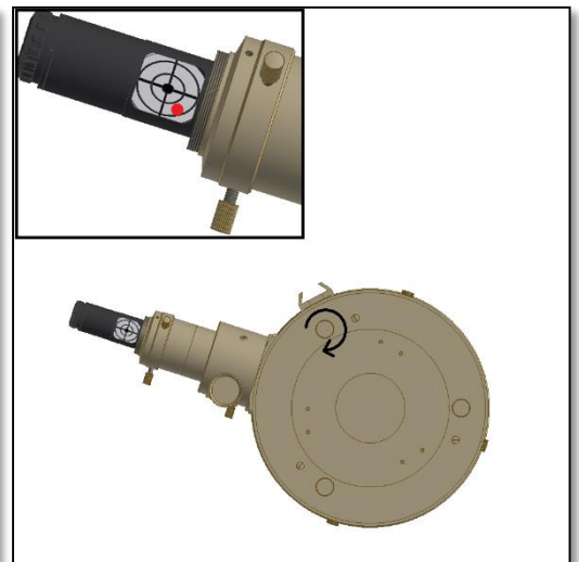
Abb 4. Den Laser-Kollimator in das Gleitrohr des Okularauszugs einsetzen. Den Kollimator genau wie ein Okular befestigen.
